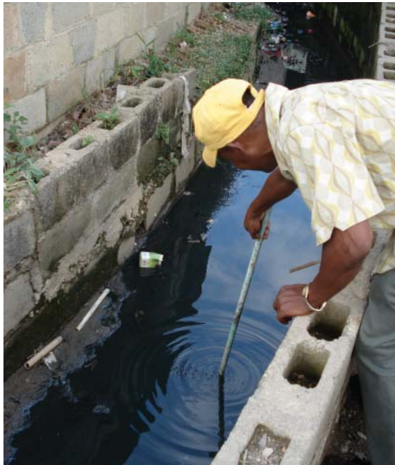
Ilustración 2.15 La profundidad de la cañada varía, por eso es importante medirla en puntos diferentes.
