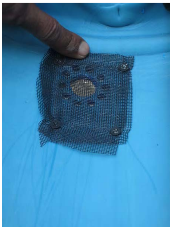
Ilustración 5.15 Agujeros de drenaje fueron cubiertos con malla en los tanques.
