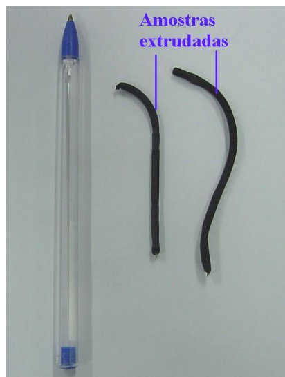
Figura 3. (a) Equipamento para determinação do MFI (b) detalhe das amostras extrudadas.
