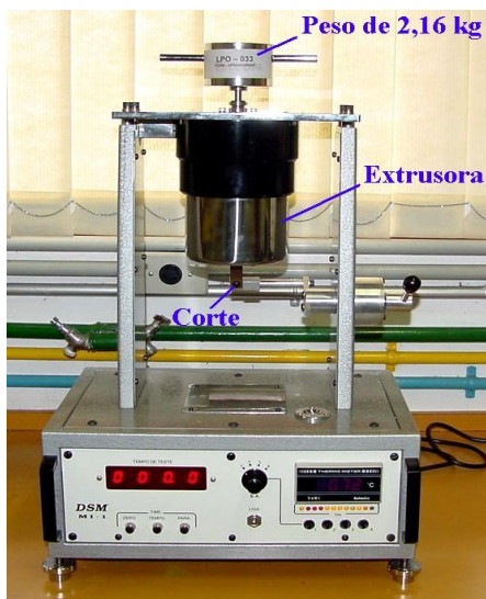
Figura 3. (a) Equipamento para determinação do MFI (b) detalhe das amostras extrudadas.
