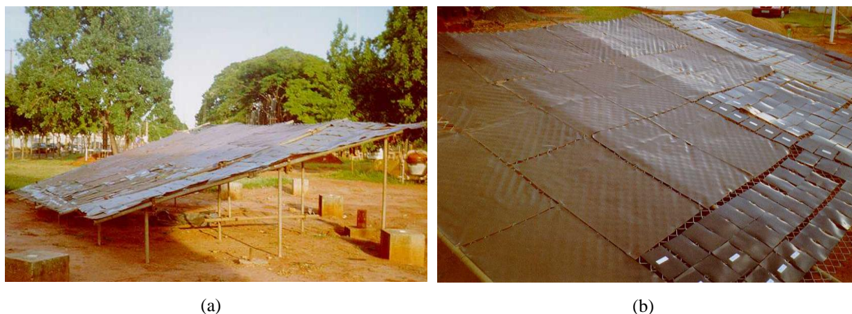
Figura 1. Amostras expostas à intempérie.
