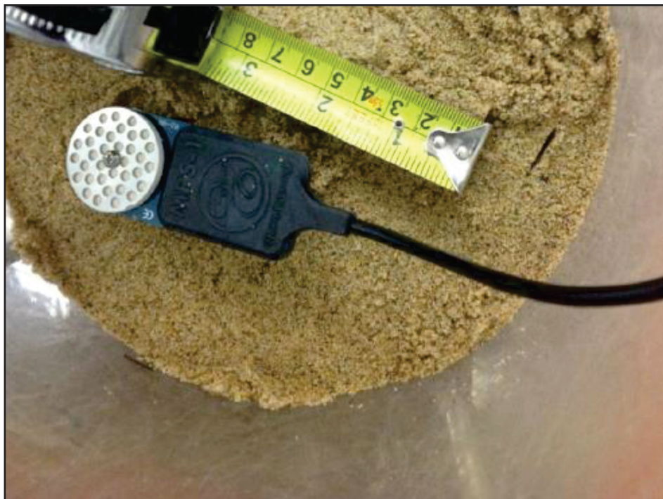
Figura 16 – Detalhe do sensor MPS-1 colocado sobre a superfície de uma camada de areia dentro do cilindro de execução da coluna.
