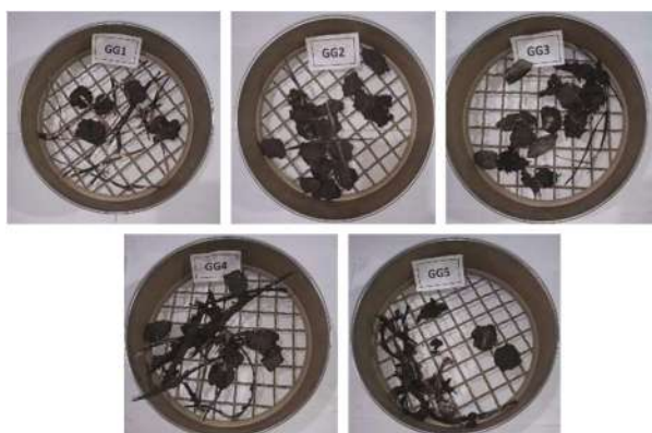
Figura 13 – Aspecto dos fragmentos de geossintéticos retidos na peneira de 19,1 mm de abertura de malha
